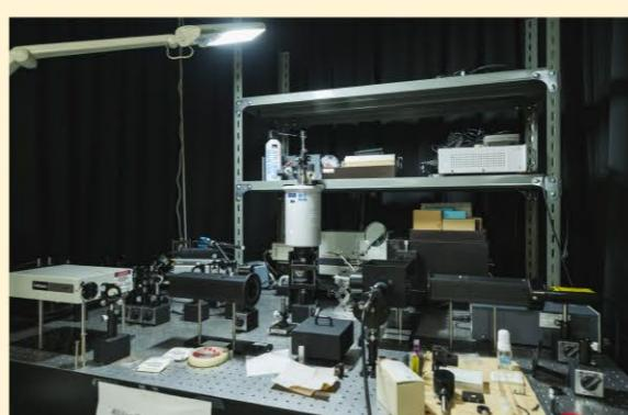
発光性金属錯体の励起状態の寿命を測定するための装置。こうした実験装置は総合教育研究棟の分析室に集められ、温度や湿度が一定に保たれた空間で管理されています。レーザーを使うので実験中は保護メガネが必要です。
