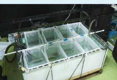
新しい実験装置。ドンコの部屋を網で仕切ることにより、水が循環し清潔さを保てる仕組み。装置を作る際の業者への見積もりや図面説明などは、長谷川さんが自ら行いました。ウナギとドンコのそれぞれの大きさが、逃げるか食べられるかにどのように関わっているのかを調べる予定。
