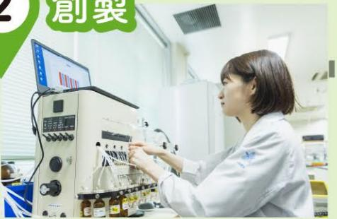
合成したものをDNAに組み込む際に使うDNA合成機。これでDNAを化学合成することで新しい素材(人工核酸)を開発します。
