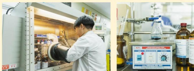
グローブボックスに窒素を充填することで空気中の酸素や水が入らない密閉空間を作り出し、空気に不安定な化合物を扱うことができます。
