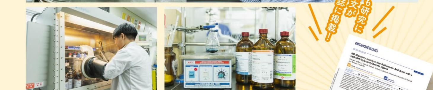
グローブボックスに窒素を充填することで空気中の酸素や水が入らない密閉空間を作り出し、空気に不安定な化合物を扱うことができます。
