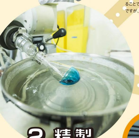
溶解度など、それぞれの物質の持つ特性の違いを利用して合成した混合物から原料や副生成物を取り除き、生成物を純粋な形で取り出します。
