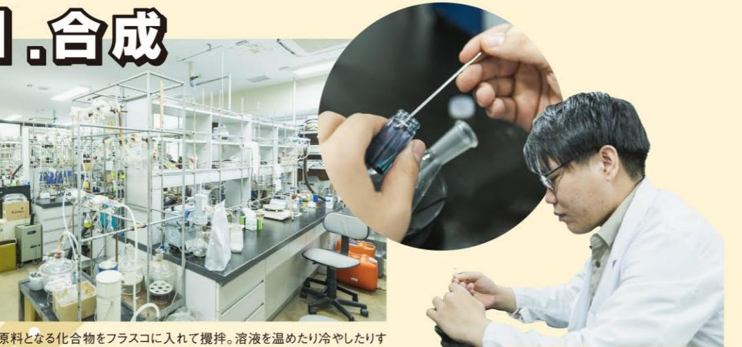
原料となる化合物をフラスコに入れて攪拌。溶液を温めたり冷やしたりすることで、新しい金属錯体を合成します。実験器具がぎりぎりと並ぶ実験室ですが、一人一人の作業スペースはきちんと確保されています。
