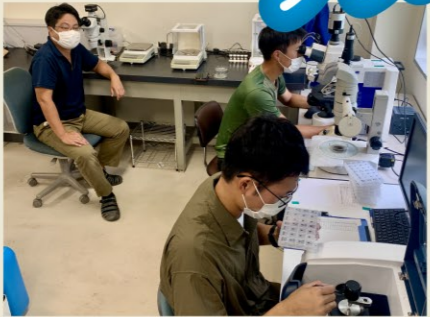
顕微鏡や専用の判定機器を使用してマイクロプラスチックを分類。地道な作業ですが、正確なデータが求められます。
