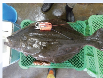
行動に影響を及ぼさないよう、なるべく大きなヒラメに計測器と小型カメラを取り付ける。一定時間が経過すると自動的に外れるようになっているので、海面に浮上したものをGPSデータを頼りに回収し、データを分析していくそう。
