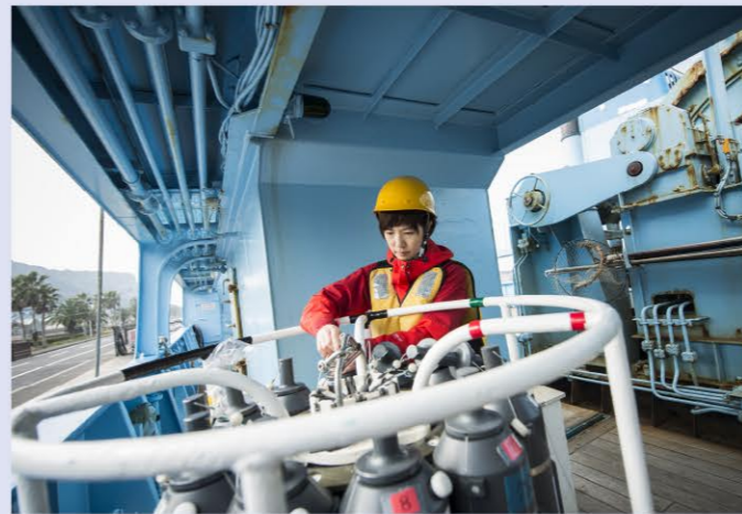
港に停泊中の長崎丸のデッキで採水器を扱う先生。このような調査器具の扱い方も実習で学ぶことのひとつです。
