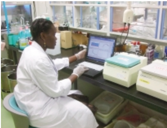
① LAMP法に用いられる定温濁度計 LAMP法を用いることで写真のような簡便な機器で新型インフルエンザ遺伝子の短時間検出(30分～1時間以内)が可能となった。写真の人物はケニアからの文部科学省国費留学生でLAMP法の研修を受けるDr.Mary Inziani Muyeku Matilu。
