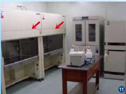
11 P3ラボ内に設置されたバイオセーフティキャビネット(矢印)。ここではエイズウイルスやSARSなども扱える。危険なバイオハザード(生物災害)の対策が施された施設はP1ラボ~P4ラボまであり、エボラ出血熱など最も危険な病原体はP4ラボ内で扱われる。P3ラボの改修とともに、電気泳動用の遺伝子研究機器、免疫研究機器、蛍光顕微鏡、電気泳動機器、血液培養、自動分析装置のほか、生活に必要な電化製品の設置もほぼ終了し、日本からの研究者が比較的使用しやすい配置となった。 12 P3ラボ建設に携わった技術者とともに。
