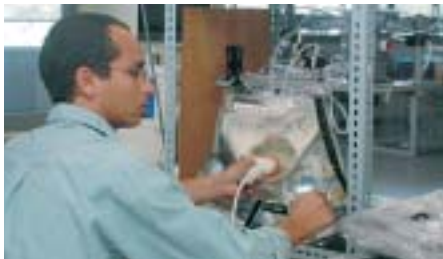
■ 「超音波を用いた蓄尿量の検出」。膀胱に尿がたまると知らせる装置。実用化もそう遠くない。
